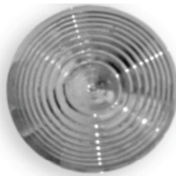
Figura 1: Lente diamagnética. La lente acústica de Fresnel se obtiene suavizando una lente acústica de una convexa. Esto permite captar señales acústicas de alta resolución y enfocar la energía a una profundidad específica. Las lentes de Fresnel están formadas por un conjunto de anillos concéntricos de anchura decreciente, cada uno de los cuales se denomina "región de Fresnel". Entre dos regiones consecutivas existe una diferencia de fase \pi . La principal contribución energética al enfoque proviene de las regiones centrales de la lente.
